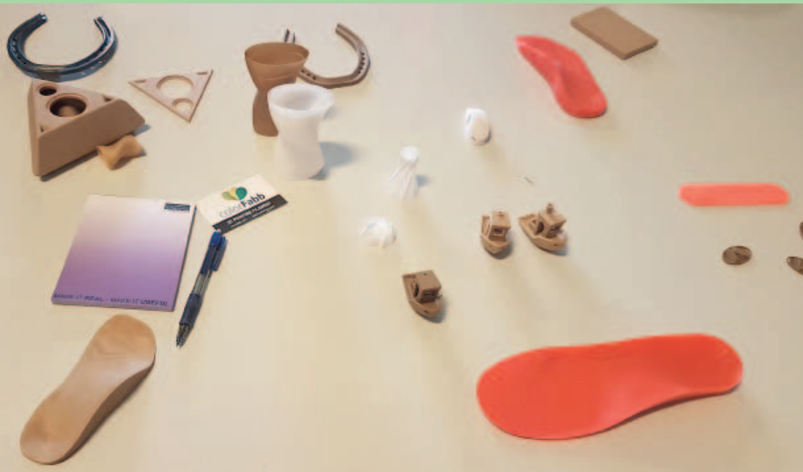
Diverse produkter tillverkade i biokomposit med 3D-skrivare. Foto: Thomas Bajer
